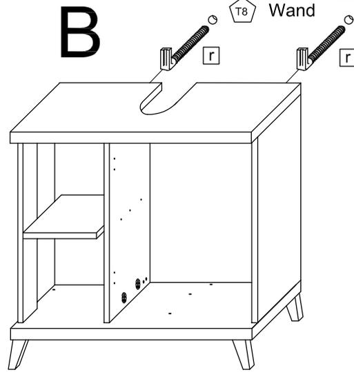
T6 Die Schrankaufhänger dienen zur Kippsicherung des Schrankes und müssen grundsätzlich montiert werden.
