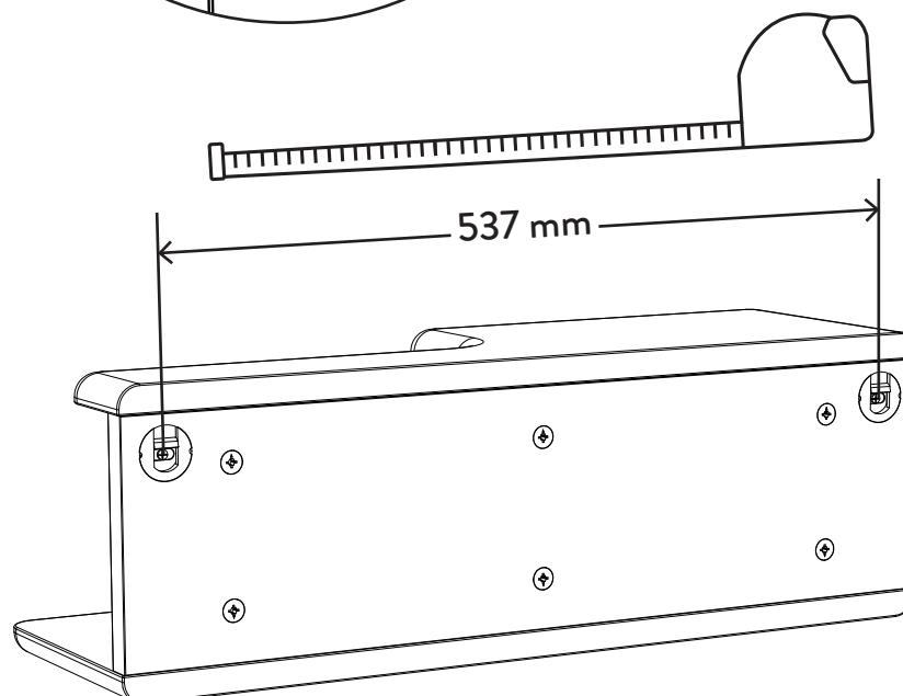
Var vänlig använd lämplig plugg och skruv för din vägg. Var noga med att kontrollera väggens beskaffenhet före montering av produkten.
